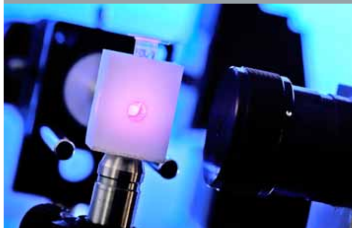
Keime erkennen: Studenten entwickelten einen Sensor, der Bakterien in Liquor-Kathetern erkennen soll
