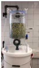
Abb. 2: Festbett-Essigreaktor mit Ingwertrester gefüllt
